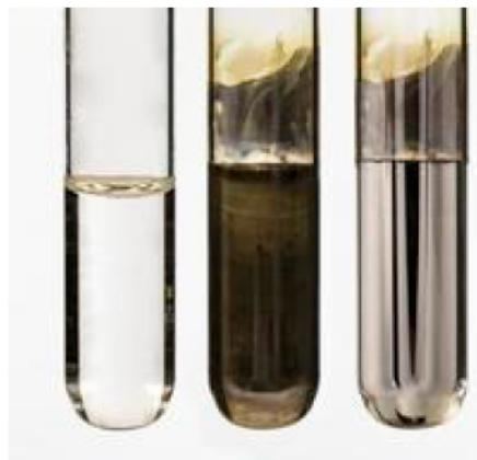
Слика 7.10. – Реакција сребрног огледала. Слева надесно су епрувете на почетку, током и на крају реакције. У последњој епрувети се може уочити елементарно сребро, које је на унутрашњим зидовима епрувете.
