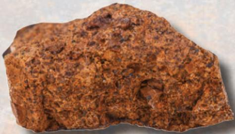
Лимонит  $\text{Fe}_2\text{O}_3 \cdot n\text{H}_2\text{O}$
