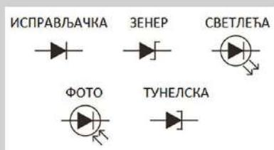
4.140 Графички симболи за различите врсте диода
