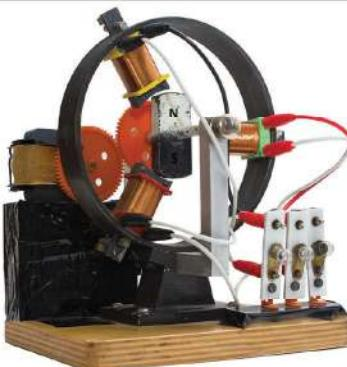
5.3 Модел трофазног генератора
