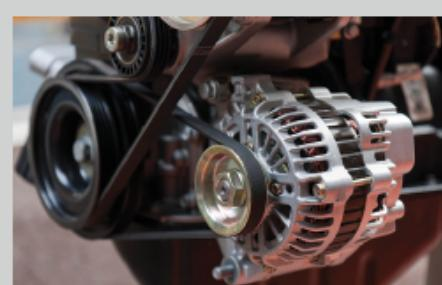
4.15 Генератор у аутомобилу (алтернатор)
