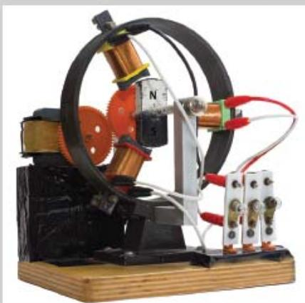
5.3 Модел трофазног генератора
