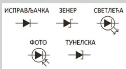
4.140 Графички симболи за различите врсте диода
