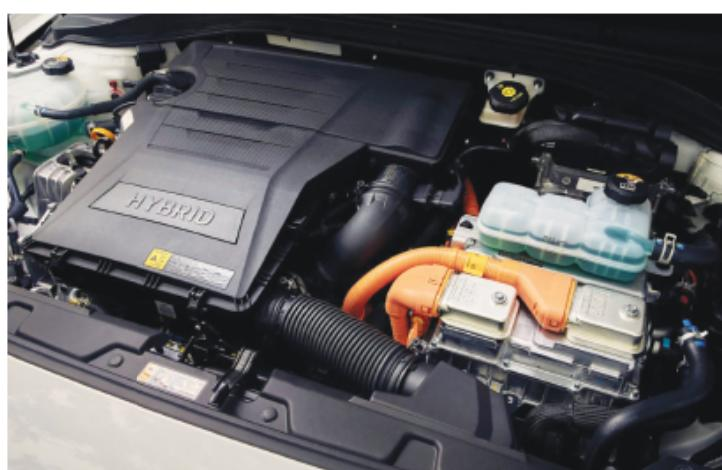
2.21 СУС мотор и електрични мотор у хибридном аутомобилу
