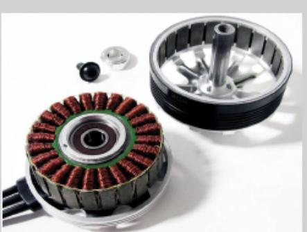
4.18 Електромотор чији је статор стални магнет
