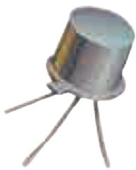
► Слика 7.14. Полупроводник јерманијум се користи за производњу транзистора.
