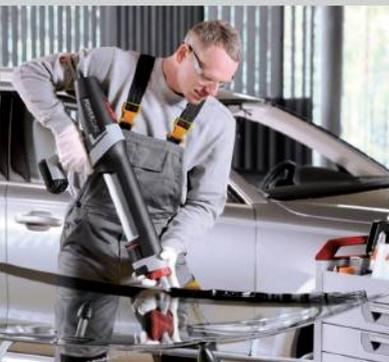
4.64 Наношење лепила на ветробранско стакло непосредно пре постављања на шасију аутомобила
