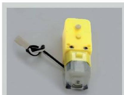
4.137 Електромотор једносмерне струје
