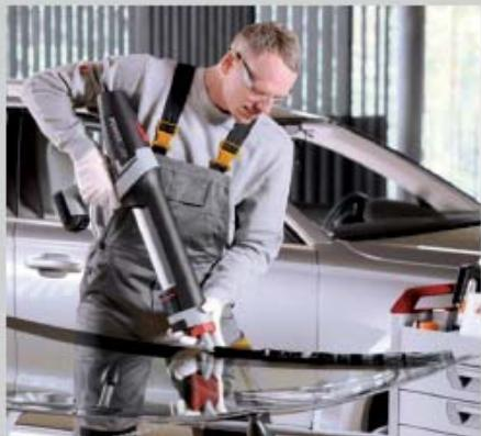
4.67 Наношење лепила на ветробранско стакло непосредно пре постављања на шасију аутомобила
