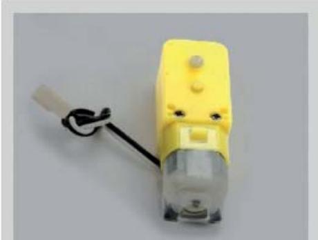
4.147 Електромотор једносмерне струје
