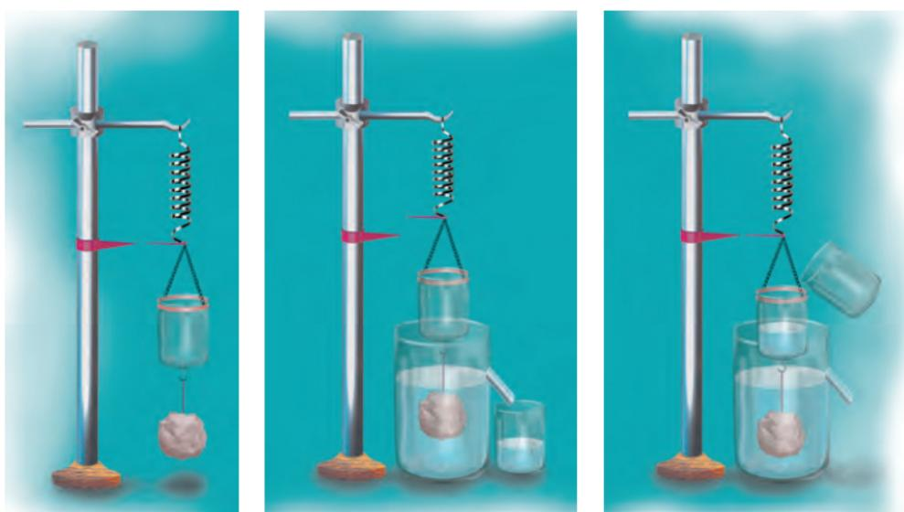
Слика 3.18 – Одређивање силе потиска
