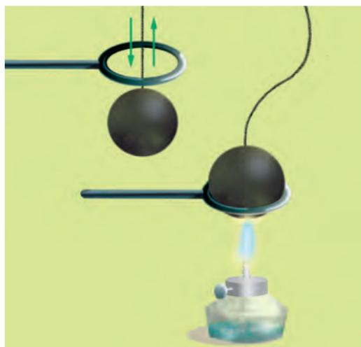
Слика 5.1 – Ширење куље при загревању
