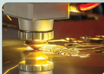
Слика 1.2.8: Ласер који се користи за сечење и обраду • метала
