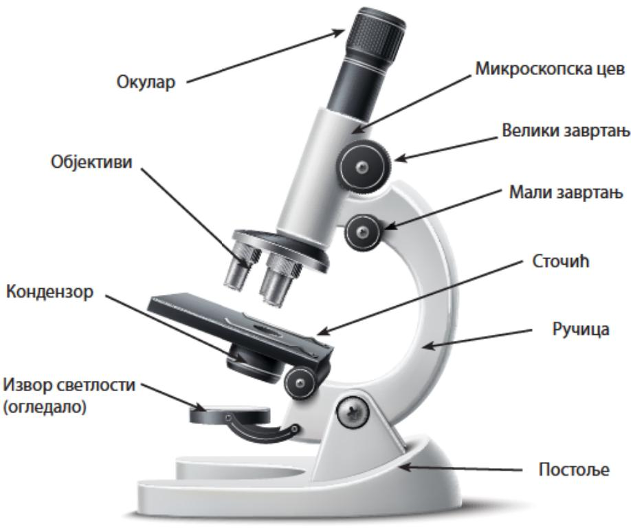
Оптички и механички делови светлосног микроскопа
