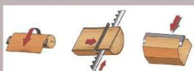
4.17 Добијање фурнира љуштењем, резањем и сечењем
