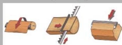
4.17 Добијање фурнира љуштењем, резањем и сечењем
