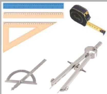
4.32 Прибор за мерење и обележавање
