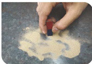
◀ Магнет се употребљава за одвајање крупног и ситног металног отпада
